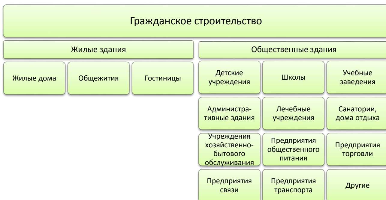
Рисунок 1. Виды объектов гражданского строительства
