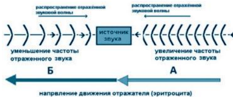
Рисунок 5. Принцип Допплера. А - увеличение частоты УЗ волны при направлении движения кровотока к датчику, кодируется красным цветом. Б - уменьшение частоты УЗ волны при направлении движения кровотока от датчика, кодируется синим цветом
